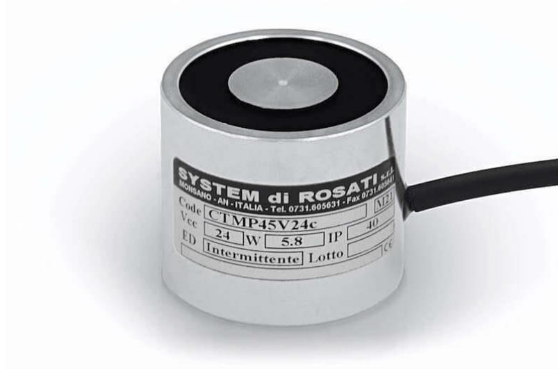
Elettromagnete di tenuta con magnete permanente tipo CTMP esercita una forza di attrazione quando non è alimentato. La forza di attrazione è infatti generata dal magnete permanente integrato e il rilascio si ottiene alimentando l'elettromagnete che genera un campo elettromagnetico di polarità inversa.
