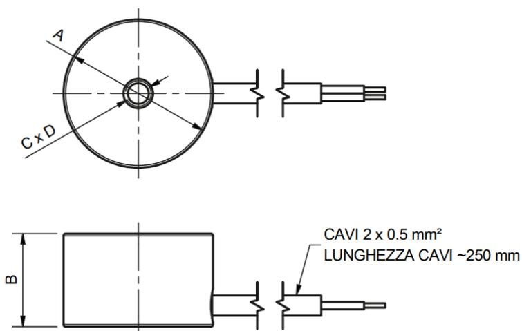
LA FORZA DI RITENUTA É IN FUNZIONE DELLA TEMPERATURA DI ESERCIZIO, DELLA QUALITÀ DEL CONTATTO TRA ELETTROMAGNETE E PARTE DI RITENUTA E DALLA TIPOLOGIA DI RITENUTA IN RELAZIONE ALLO SPESSORE, ESEMPIO: RITENUTA DI DISTACCO, RITENUTA DI STRISCIAMENTO, RITENUTA DI ROTAZIONE. LE FORZE INDICATE SONO RIFERITE AD UNA RITENUTA DI DISTACCO, CON UN UNICO CICLO DI LAVORO A TEMPERATURA DI 20°C E CON PARTE DI RITENUTA DI SPESSORE 6 mm DI DIAMETRO UGUALE A QUELLO ESTERNO DELL' ELETTROMAGNETE.
